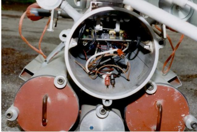
Wenn Du durch Anklicken das Bild vergrößerst, wird Dir im Innenraum oben die mechanische Ansteuerung der beiden Motorgondeln auffallen. Die Montageplatte für die Elektronik wird in seitlichen U-Profilen geführt.
