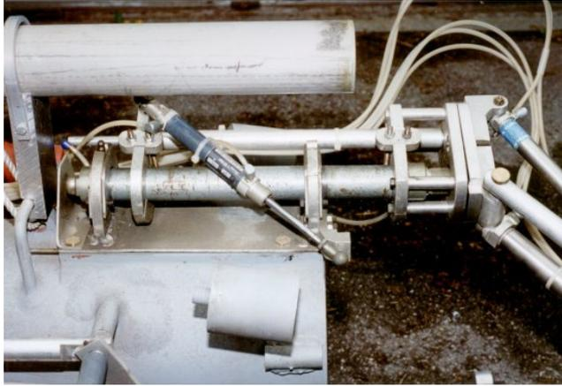
Derselbe Pneumatikzylinder wie zuvor, nur ausgefahren, so dass der Manipulator nach rechts geschwenkt worden ist.
