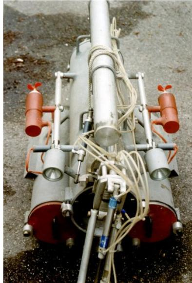
Hier sieht man die Aufhängung der schwenkbaren Antriebsgondeln rechts und links. Außerdem sind die beiden Bugscheinwerfer und ein Teil der Pneumatikmechanik des Manipulators zu erkennen.
