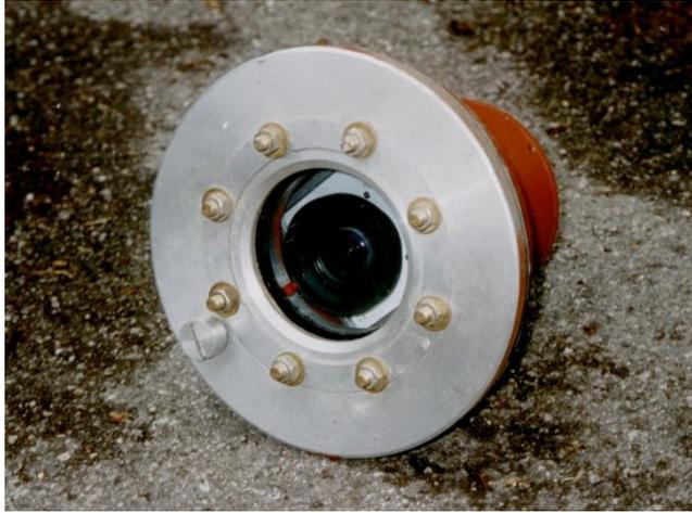
Hinter dem Bugverschluss ist eine Kamera erkennbar.
