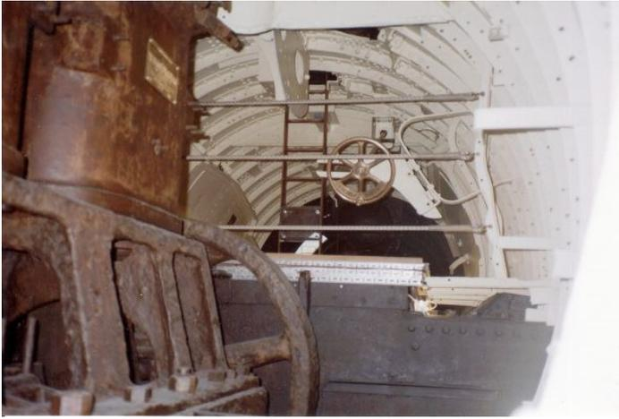
Nach zehn Jahren war das Boot so stark korrodiert, dass es erneut dringend gegen den Rostfraß geschützt werden musste. Die bisher angewendeten Methoden lösten das Problem nicht. So tauchte man die Holland schließlich für vier Jahre in einen 800000 l fassenden laugenhaltigen Tank. Dadurch wurden die Salze im Metall neutralisiert. Das Foto zeigt einen Blick in Richtung Bug des Bootes - entsprechend dem rechten Kreis des zweiten Bildes.
