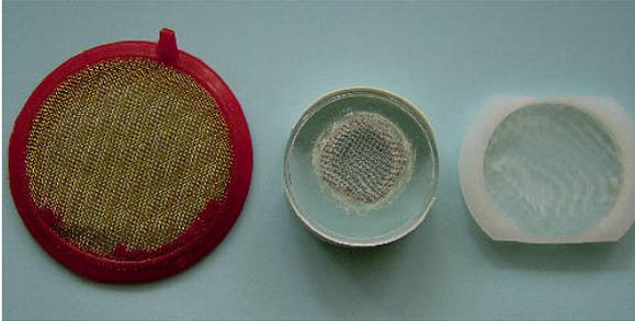
Mit Hilfe von Filtern schützen wir die Tauchpumpen unserer Modell-U-Boote vor Verunreinigungen. Diese sinnvolle Maßnahme kann aber auch Nachteile haben.
