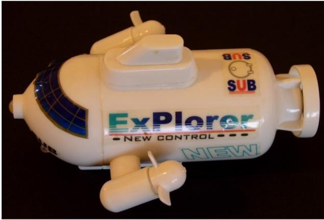
Bei anderen Mini-U-Booten sorgen schräg nach unten gestellte Motoren für das dynamische Tauchen. Dadurch entfällt ein zusätzlicher Motor für die Vorwärtsfahrt, wie er bei Modellen mit einem senkrechten Tauchantrieb erforderlich ist. Die schräg gestellten Motoren sorgen für beides gleichzeitig, den Vortrieb und das Tauchen.
