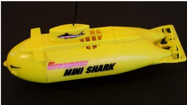
Bei diesem Mini-U-Boot, dem MINI SHARK der Fa. Graupner, wird das Auf- und Abtauchen mittels eines senkrecht und mittig eingebauten Antriebs erreicht. Er befindet sich hinter dem Schutzgitter und kann vom Sender aus betätigt werden. Da das Boot mit Restauftrieb taucht, genügt es zum Auftauchen, den Motor einfach abzuschalten.
