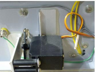
Das Servo für die Regelzelle auf der Unterseite des Druckkörper-Verschlussdeckels.
