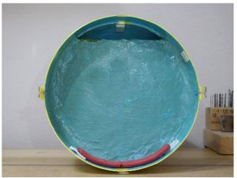
Beim Heckteil sieht man im unteren Bereich ein eingeschrumpftes Stück Trimmblei. Der eingespritzte Schaum wurde mit Glasfasermatten vor mechanischen Beschädigungen geschützt. Teilweise ist hier inzwischen die Farbe abgeplatzt.
