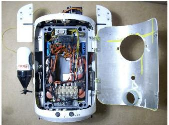
Die Aluhülle hat einen Deckel mit Scharnier und zwei Laschen, die nach dem Zuklappen nur eingeschnappt werden müssen.
