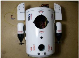
Das Mittelteil der Alu mit den drei Löchern im Deckel für den Turm, die Stabantenne und die Rettungsboje.
