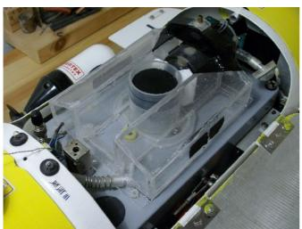
Die Alu taucht mit einem Tauchtank der aus Plexiglas gefertigt ist und kann dann mit einer Regelzelle millilitergenau auf's Schweben eingestellt werden. Die Regelzelle besteht aus einer gekürzten Spritze aus der Apotheke und ist senkrecht eingebaut. Sie wird von innen mit einem Servo betätigt.
