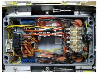
In der Box befindet sich die Elektronik. Die Zahnradpumpe wird von einem Servo mit zwei montierten Mikroschaltern gesteuert, entsprechende Elektroniken konnten mich bisher nicht überzeugen. Zur weiteren Sicherheit habe ich alle Stromkreise einzeln abgesichert.
