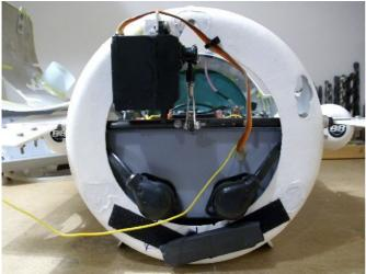
Tiefenruder- und Gondelschwenk-Servo sind beide außen montiert und natürlich abgedichtet. Das mache ich immer mit flexiblem Sekundenkleber (Flexofly – gibt es aber glaube ich nicht mehr, so dass ich mir beim nächsten Mal auch etwas Neues suchen muss).
